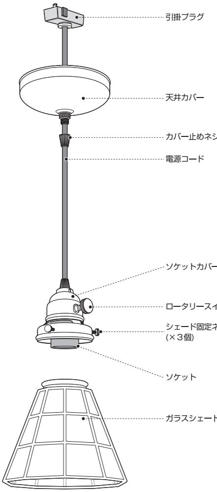
推奨電球 (口金のサイズ) E26 (ワット数) 40Wまで (電球の形状) ハウス電球
