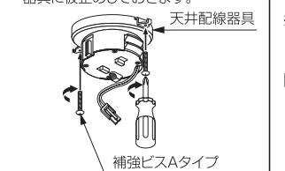
2.補強ビスAタイプを通しながらプラグにシーリングプレートを取り付け、左に回して図Aの位置に仮止めした補強ビスAタイプがくるようにし、ドライバーでしっかりと締めてください。
